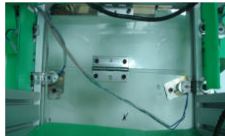
圖十八、此為置物槽電磁鐵
