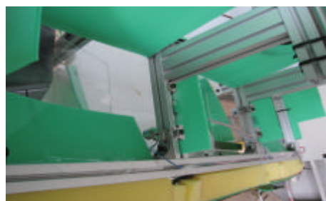
圖十二、壓克力板製作而成的閘門
