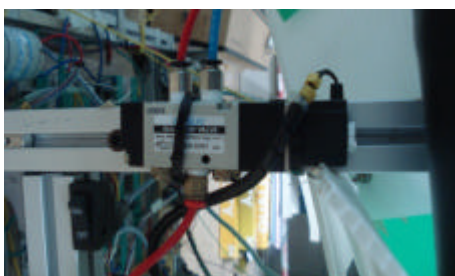
圖十、此為五口二位電磁閥
