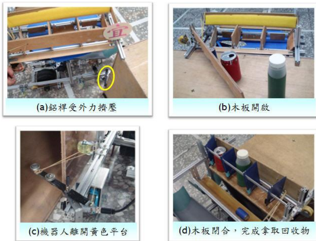
圖 7 拿取回收物機構分解動作示意圖
