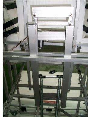
圖 4 擋板機構（擋板與擋板滑道）
