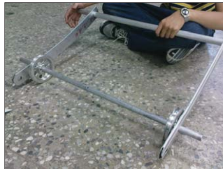
圖四 ( 過鴻 溝、抓取台 車的手臂機 構 )
