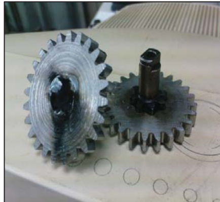
圖五 ( 齒輪 比將近 1 比 1 左圖為車 輪齒輪，右 圖為馬達齒 輪 )
