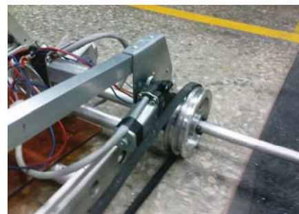
圖七 ( 皮帶作為動力，惰輪輔助皮帶運作順暢 ) 圖七 ( 起落架 )
