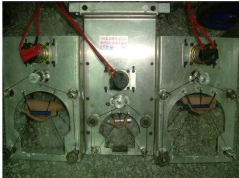
如何將繩子收回而呈現夾持的功能呢?其實原理是利用馬達的帶動，使用時規皮帶與時規皮帶齒輪的傳動間，造成旋轉，在馬達令一端的時規皮帶齒輪上，有一個軸裝著收線器，分別在鋁板的上下，即可形成面來接觸，在齒輪與齒輪之間，做了一個可以移動的距離，可以在裝置時規皮帶的時候更順暢或是更確實這是在皮帶傳動裝置上面所看到的靈感。
