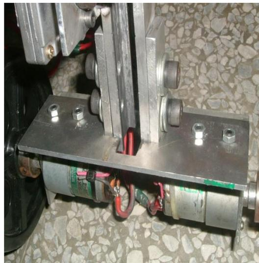
這機構還有一個特別的地方就是輔助輪，因為第三關要爬階梯與跨鴻溝，輔助輪的結構就比較簡單些，跟帶動齒輪的方法一樣是利用卡拉的原理，使其馬達軸帶動輪子做前進後退的動作，其馬達的規格是 120RPM 因為行走不需要高扭力所以就選用高轉速的馬達也比較好找剩下就只有配電線路的問題就可讓馬達正轉反轉，在使用輔助輪行走的時候發現到了整個套筒會受不了整體的重量而產生變形，讓輔助輪呈現八字型的樣子行走，因為套筒是為了要輕所以就用強度不夠的鋁做，所以容易產生變形，為了防範這個狀況，因此又做了加強版的部份，加強版中間的洞口是為了不會干涉到齒條行進，主要的功能就只是讓整個升降機構更為堅固在上升與行走時不會變形讓整個套筒在分開變形而限制的形狀。
