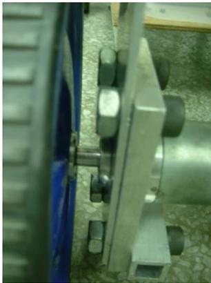
在車體上安裝了四顆馬達跟四個輪子，是因為讓每一個輪子分擔掉本體的重量，帶動車體時更能更加靈巧且機動性強，雖然有考慮上每顆馬達的速差問題，但影響不大。在馬達的選用上有 AC 和 DC 兩種選擇，但我們選擇 DC 直流馬達(24V)的原因為：控制技術較為簡單，安全性高，可正逆轉，有軸向運動的空間且價格上還是在考慮範圍內。在馬達上的裝配，馬達上裝有軸心帶動輪子，更加上馬達連結器搭配上門型鋁版結合，在門型鋁版上加有培林跟套圈，是為了讓軸心在一直線上不會偏掉，再以缺氧膠(逆向工程材料)黏合。
