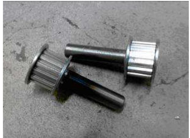
圖五 前輪軸貫穿皮帶輪
