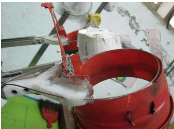
4. 渦桿渦輪:我們用來旋轉取物品動作,可以穩定的動作完成任務。
