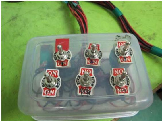
這次設計操控盒跟往年一樣，也是用 6P 開關進行正逆轉控制，在設計操控盒可能要操作手親手做，才能知道如何的操作，為了這次的電壓分為 12V 跟 30V 的電壓，在 12V 電壓運用取物品的使用，其他就用 30V 電壓控制。
