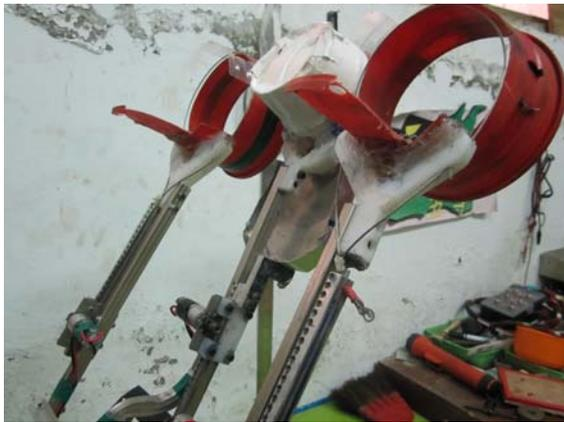
3. 套取設計:我們設計 Y 型零件,在 Y 型頂端鑽孔,再鑽孔拉線來夾取物品,外圍花瓶可以讓回收物傾倒。
