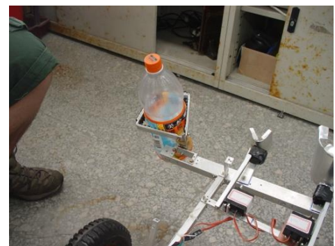
(圖 2 寶特瓶夾取測試)
