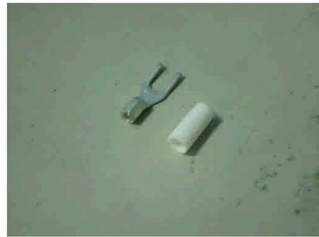
圖 15 壓接端子與標籤套管
