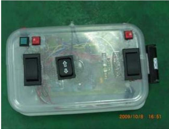
2. 利用了 IC 2248 編碼晶片來當發射電路, 以及 IC 2250 解碼晶片來當做解碼, 且 IC 2250 共有 18 個控制點可來控制機構, 紅外線遙控距離無法跟無線電波一樣遠。
