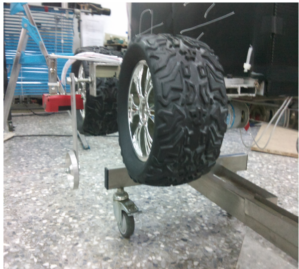
圖六 機器人兩旁的輔助輪(後方照)
