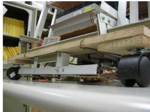
圖 15: 底盤機構後輪，以 2 個兩個萬相轉輪輔助。
