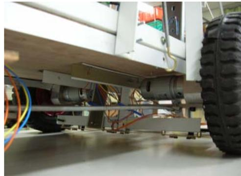
圖 14: 底盤機構前輪，以 2 個直流馬達直接耦合方式驅動
