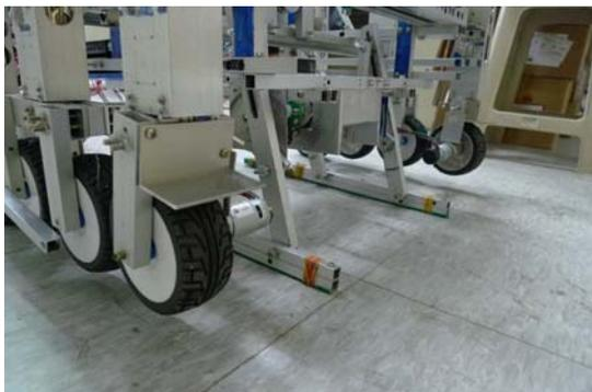
圖 3-4(b)腳底板的高度低於升降機構高度
