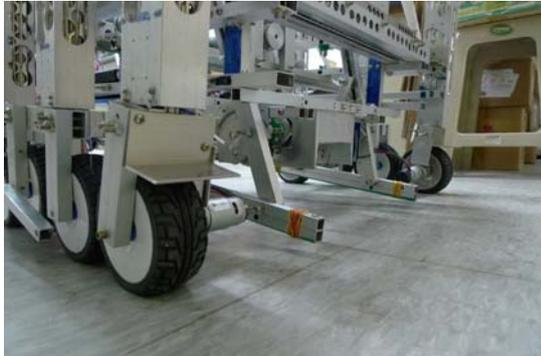
圖 3-4(a)腳底板的高度高於升降機構高度
