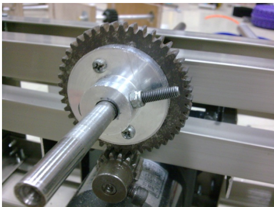
圖 8.3、以鐵棒為傳動軸
