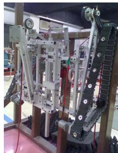
圖 21：初代設計機測試攀爬
