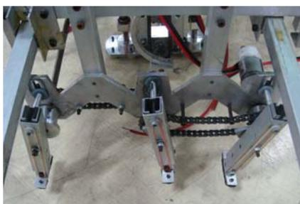
圖 1：機器人步行機構
