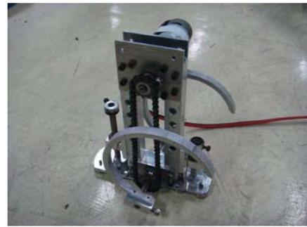
圖 18：中央輔助結構(側面含雙掛勾)
