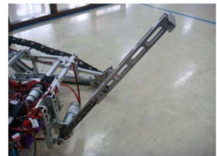
圖 20：調整長度後的開啟機構
