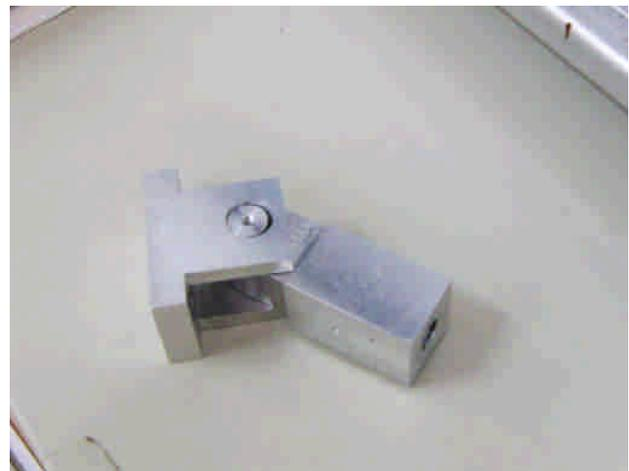
圖 5 踢球機構中的連桿機構
