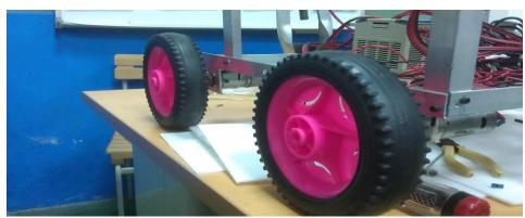
採用 4 顆馬達用來帶動輪子,把程式編寫好輸入 PLC 裡面,利用感測器去感應物件,PLC 收到感測器所感應到的訊號,經過 PLC 的程式來帶動機構,使綠豆沙一號可以移動。
