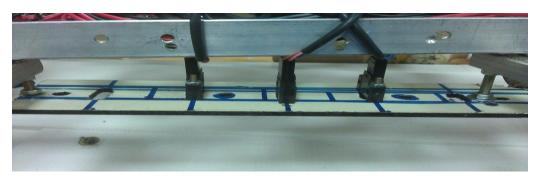
土石流區需有避障之功能,所以使用光纖感測器來分辨顏色使用來避開障礙物與 夾取娃娃和黑線感測器循著黑色行走如果出黑線會自動修正在回歸黑線。
