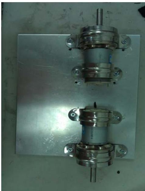
圖五底盤的馬達
