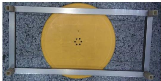
圖一·底盤框架(由四支鋁條及四個萬向接頭組合而成)
