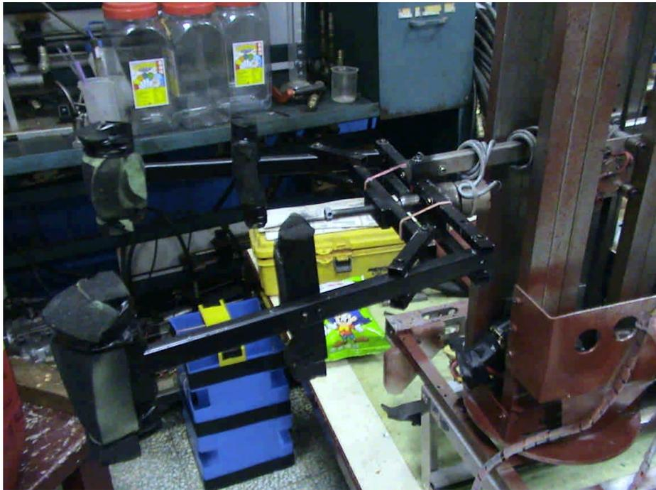
(1)、伸縮功能：抓取機構形狀類似三叉戟，前端為抓取的功能；後端則是作為伸縮機構之齒條，齒輪設置在輔助升降機構上並藉由馬達正反轉驅動。
