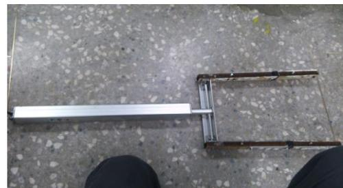
圖九；手臂電動缸(致動器)
