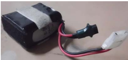
由於機構的優化，電源的部分只需四顆 12V 鋰電池即可帶動整台機器。
