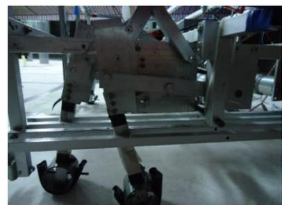
打滑，我們還特別製作腳掌以增加機構與地面的摩擦力。為了提供充足的努力與速度，這次的傳動系統的設計為，一個馬達帶動一組腳，利用鏈條來傳輸動力。
