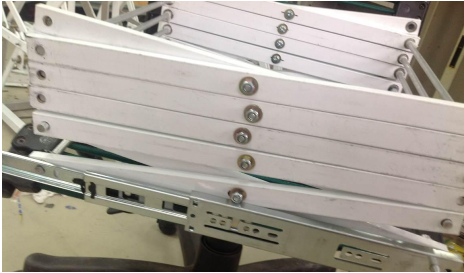
圖 5-5 升降機構(五層，已修正)
