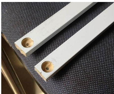
圖 5-1 塞完木頭鑽完孔的鋁擠型
