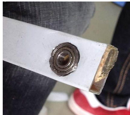
圖 5-2 塞完軸承的鋁擠型
