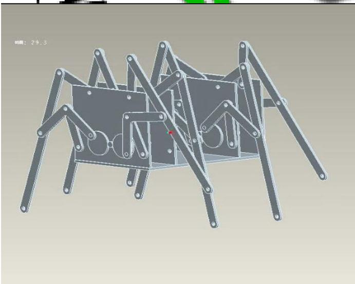
先將蒐集到的資料彙整之後並用 PRO E 做出大致上的模擬 3D 圖出來，最後在細部調整尺寸讓其能符合這次比賽的需求，
