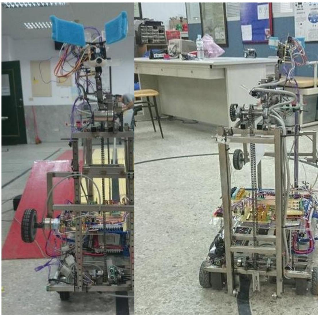
說明：機器人的正視圖，從正視圖中夾具由兩片壓刻板製作而成，夾具下的顏色感測器用來判斷之聖杯顏色，而升降裝置上面則是搭配極限開關，讓程式能帶動馬達運轉，順利進行升降之功能。
