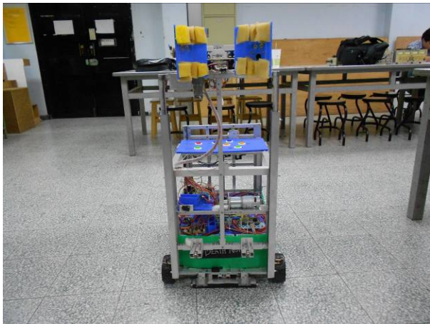
前方的伸降支架下面加裝兩個輔助輪，讓升降速度更快速。 右側圖
