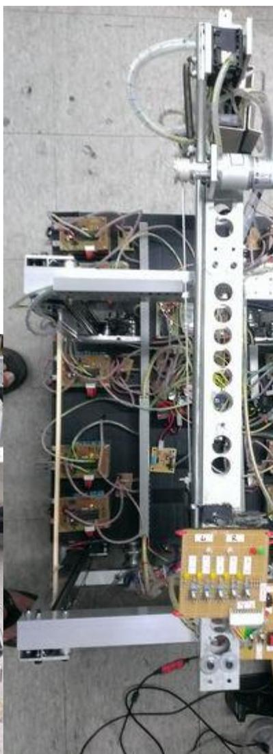
說明：機身上乘載九個自製的馬達驅動器，每個驅動器都設計有保險絲，有效保護馬達電流與控制的穩定度。
