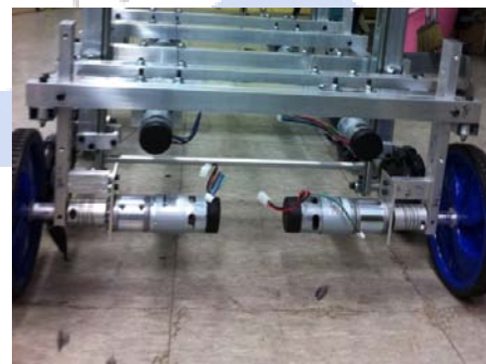
▲圖 6 主動輪直接驅動設計
