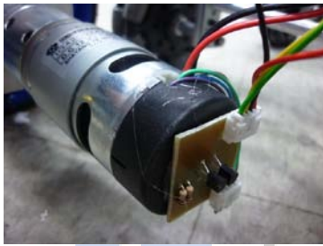
▲圖 13 馬達回授的訊號放大電路
