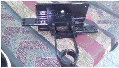
夾取手臂是由鏈條理念下去設計，當夾緊時使聖杯不輕易脫落。當到指定位子時可準確投入指定區域。
