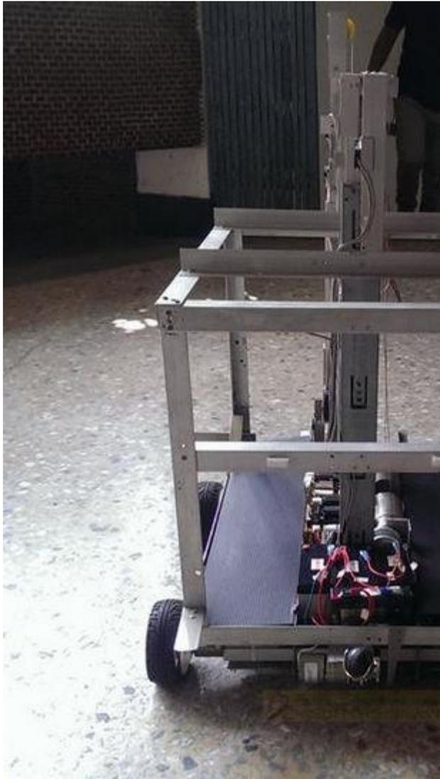
說明：加上輔助鋁軌強化車體結構使車身更加穩固。
