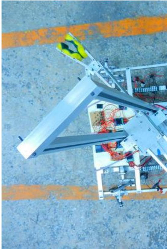
說明：整個骨架略為龐大，但是結構簡單、穩固；上升的機構為窗溝軌道，裡面有滑塊，便於使用。
