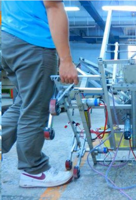
說明：底部馬達可以旋轉整隻夾爪手臂，腳底則是利用橡膠，鋁塊組合成，有貼砂紙防滑。
