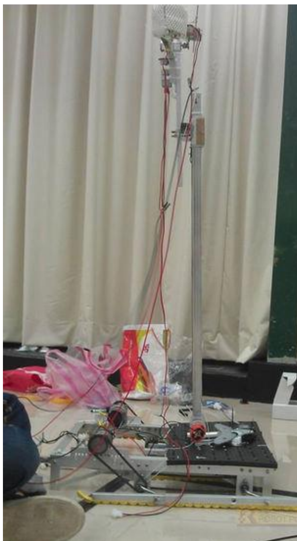
說明：機器人用單顆馬達帶動鍊條齒輪 使腳部機構用轉。
