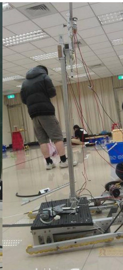
說明：機器人用單顆馬達帶動鍊條齒輪 使腳部機構用轉。
