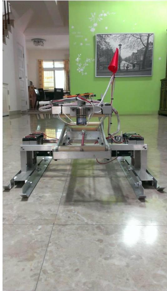
此張為我們機械人之正視圖，可以大體的看出我們的機械人整體上並不複雜，和機械人簡介中的簡單實用為目的所製作出來的，而途中正中央有一個不銹鋼外殼的小馬達，正是驅動迴轉臂的用途，接觸地面的部分可以明顯的看出有 4 支長條角鋁，可達到一顆馬達傳動 2 支腳，是兼具速度及平衡的設計，此外也可看出我們的機械人將比較種支零件設計得比較貼近地面(如馬達，電池等等)，因此行走起來非常平穩
