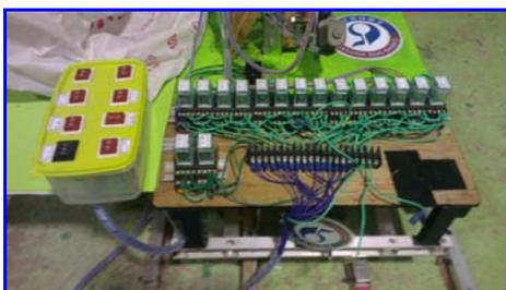
↑ 圖五(繼電器和搖控)      圖六(夾爪) ↓
