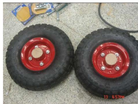
圖 2 木製材料與車輪的內軸結合
