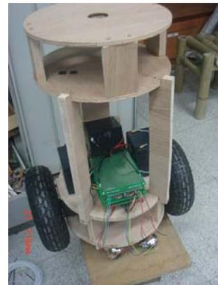
圖 6 電路板控制系統已安裝在底盤上
