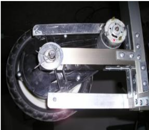
圖 2 馬達與車輪之結構
