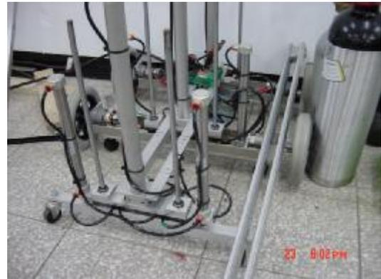
3. 跨越障礙裝置經由數次修改之後，決定使用三支行程 300mm 雙桿氣壓缸座伸縮動作，但是由於三支氣壓缸的收縮與重心的配置相當難抓取，所以決定以手臂的伸縮及旋轉動作來作重心的配置。
