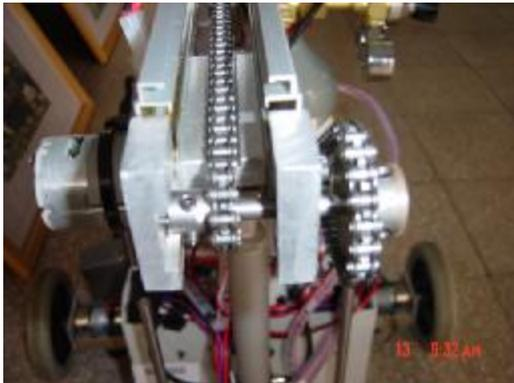
5. 手臂前端也做了可伸縮裝置，來彌補跨越岩漿區長度的不足，傳動方式則是使用時規皮帶來作帶動，中間使用導桿及線性軸承來固定伸縮方向。前端還製作可動關節，來調整抓球及放球角度
