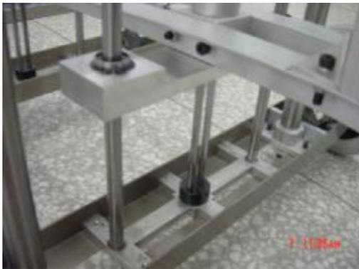
2. 起初構想是採用六輪傳動，利用兩邊馬達同時正反轉，來達到轉彎的目的，不過實際操作的時候發現迴轉並不是很理想，輪與輪之間摩擦阻抗大，傳動不確實。後來決定縮短前輪寬度，並不加裝馬達，採用活動輪增加轉彎的自由度。
