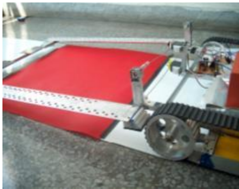
圖三 運用伺服馬達放置橋樑之機構
