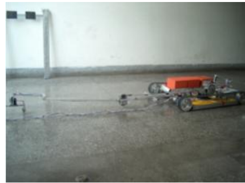
圖四 鑽穿雷射區車身變形至 20cm 以下
