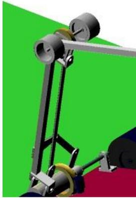
圖 1 機械手臂水平移動之平行四邊形機構模擬
