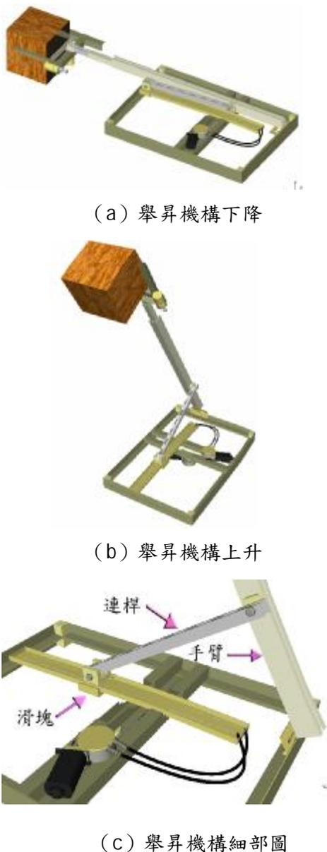
圖 4 線控機器人之舉昇機構
