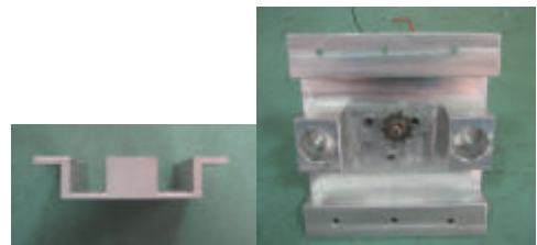
圖四：鋁塊加工而成後導座。
