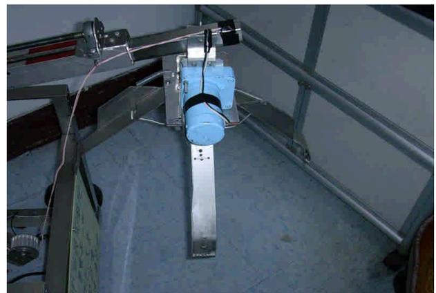
【圖一】這是手爪的部分，由 24 伏馬達所帶動，手爪的爪力非常強勁，連鋁罐瓶都可以輕易的抓破。
