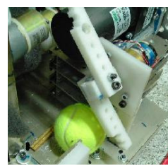
圖二十二 打球機構
