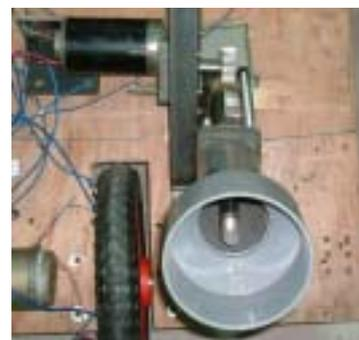
圖五 彈射機構完成圖
