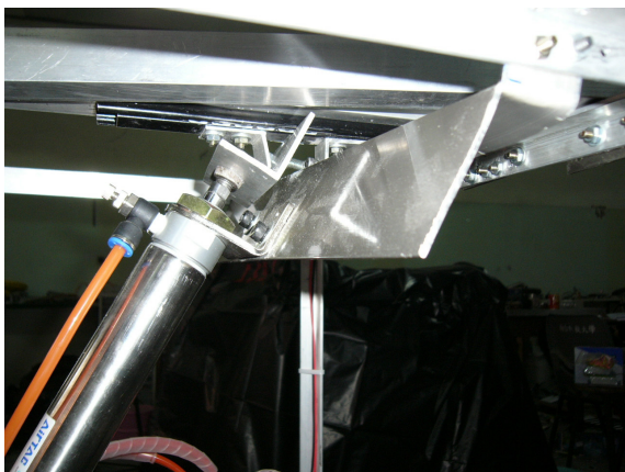
圖四: 小彈簧為防止脫離L型鋁板脫離的設計
