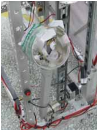
圖 10 這是抓紅色網球的一個機構（它會倒下抓紅色網球再立起來把球放入瓜子中）。
