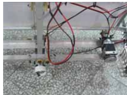
圖 7 是球箱上升動力的部分和收球機構上升動力的部分 分球器：
