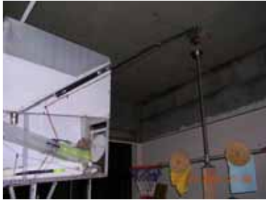
圖 9 機械手臂和放紅球的夾爪再放紅色網球置入轉動天平頂端的金杯內
