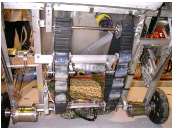
圖 2 跨越機構之腹底皮帶
