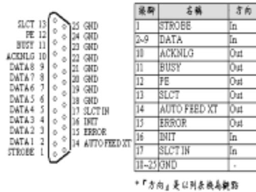
圖七 並列埠 DB25 端子接腳圖
