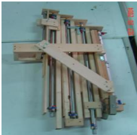
圖 6 機器手臂氣壓重疊原理
