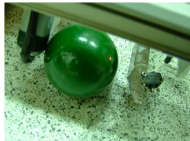
圖二十一 雙極限開關踢球、停止過程
