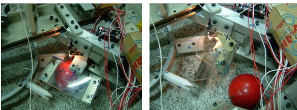
圖二十 自動辨識球過程
